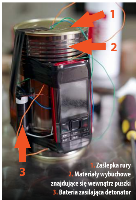
Rys. 4. Schemat bomby rurowej
